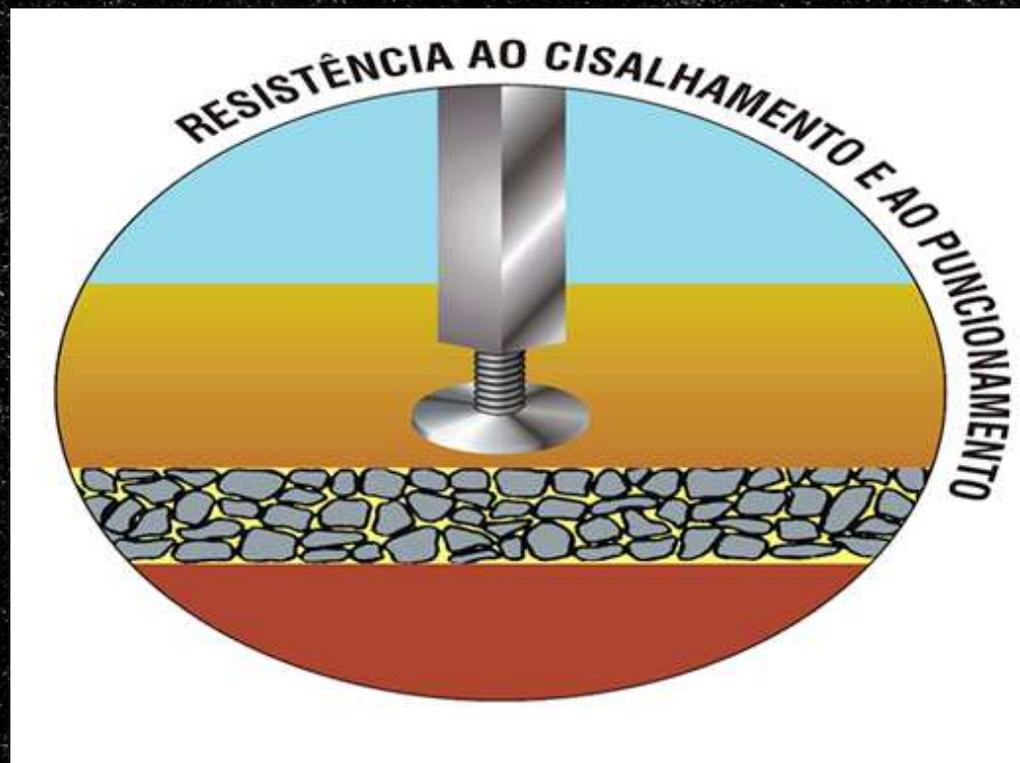
Sobre base apropriada, Concrefalt pode apresentar resistências ao puncionamento de 30 Mpa ou mais.
